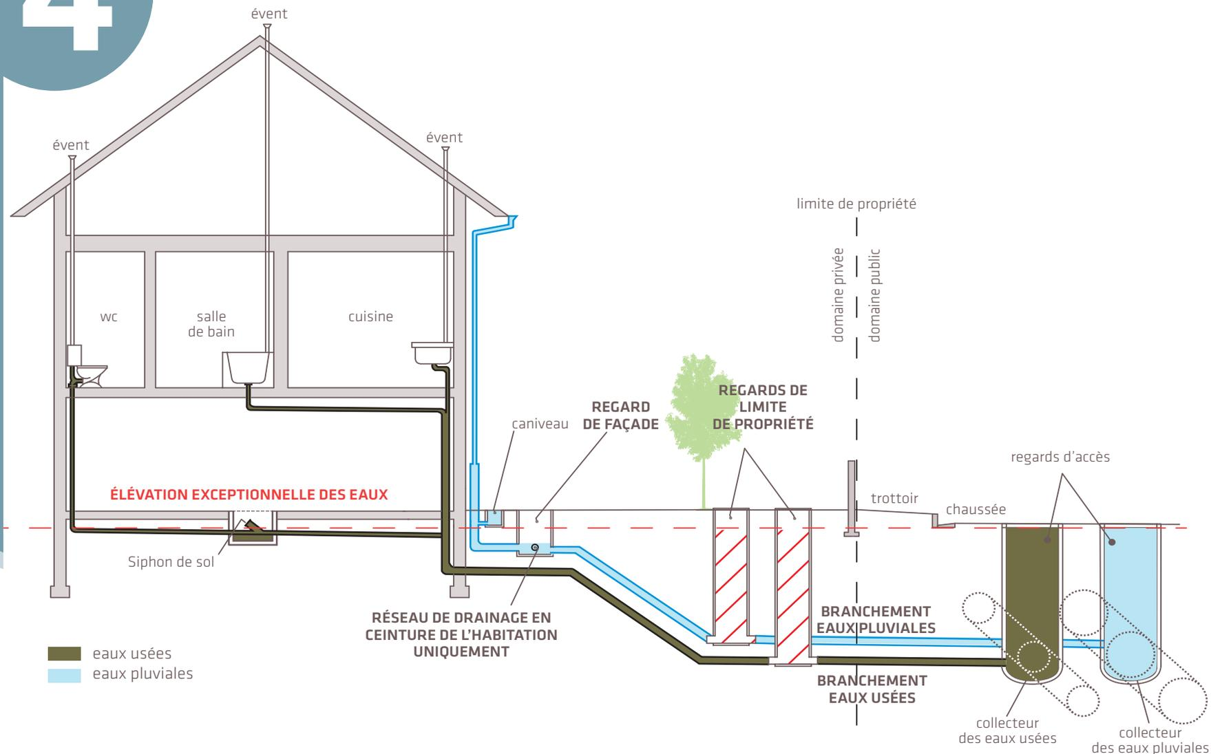
Interdiction formelle de raccorder les eaux de drainage sur le collecteur eaux usées ou unitaire
