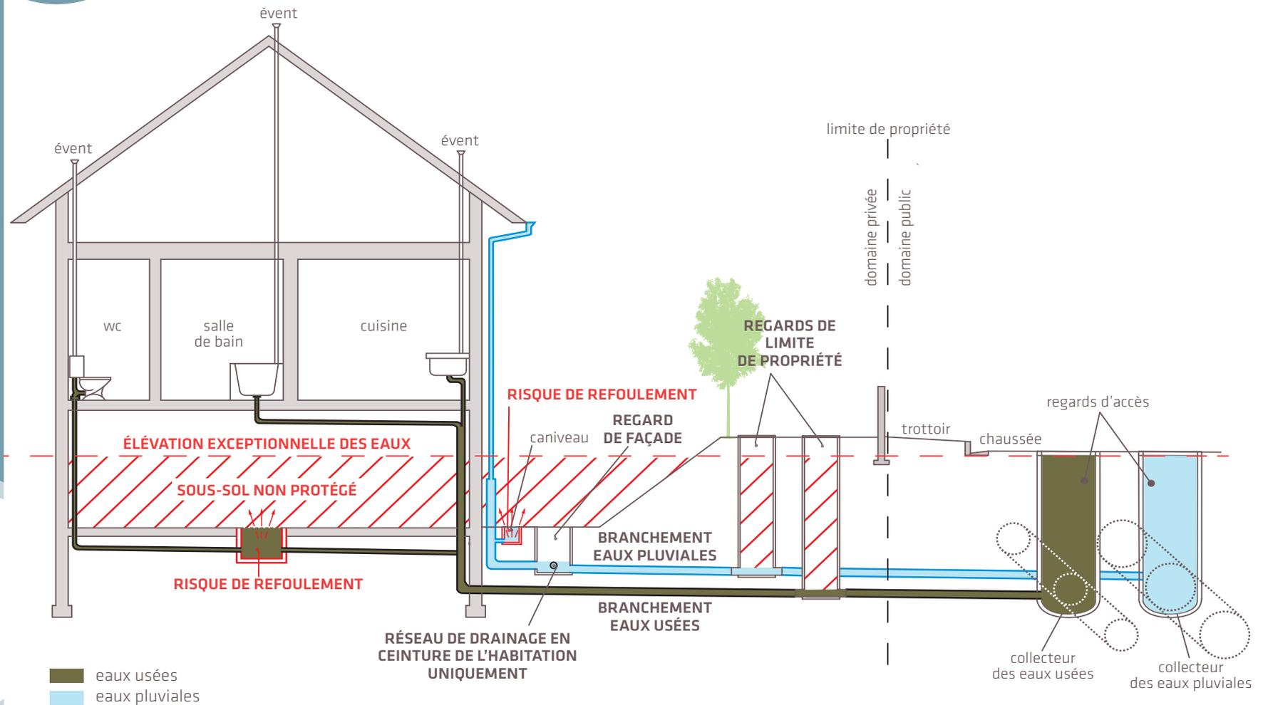
Interdiction formelle de raccorder les eaux de drainage sur le collecteur eaux usées ou unitaire
